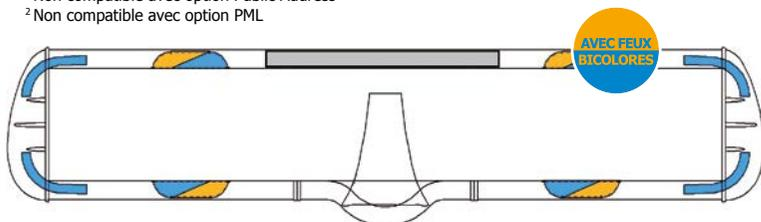
Modèle présenté : rampe VEGA avec sirène intégrée, feux bicolores bleu/orange à l'avant et à l'arrière et option PMV.
